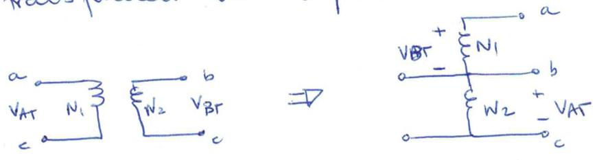
Nesse esquema a potência que o transformador pode assumir é maior, no entanto o ~~terminal~~ terminal de baixa tensão <sup>(ab)</sup> tem que suportar o potencial total (ac)
